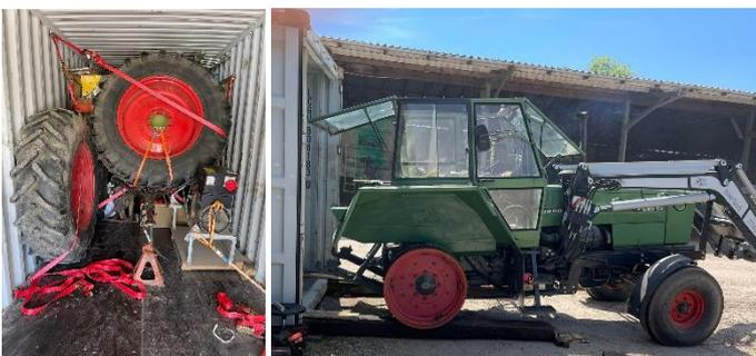
mit kleineren Felgen wird der Traktor in einen "40 Fuß High-Cube"- Übersee-Container geladen ...
